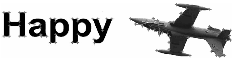
图 3.1.5 用 SUSAN 算子检测到的角点
