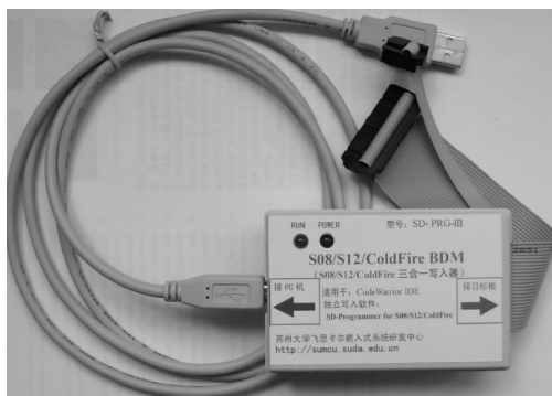
图 3-5 S08/S12/ColdFire 三合一写入器实物图
