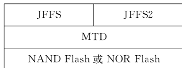
图 3-4 应用 JFFS/JFFS2 的块设备层次结构图
