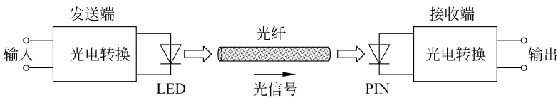
图 3-12 典型的光纤传输系统结构
