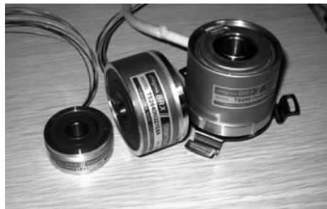
图 5-12 日本多摩川公司的旋转变压器实物
