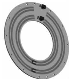
图 5-9 采用冗余设计的 关节电位计
