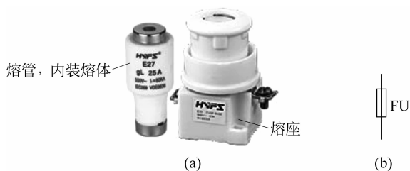
图 1-1-10 低压熔断器的结构及符号
