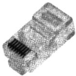
RJ-45 插头是在以太网网络中常见的接口。其电缆的两端各有一个 RJ-45 插头，如图 3.4 所示。
