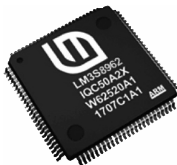
图 3-2 处理器 LM3S8962 外形图
