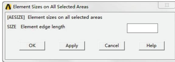
图 5-34 所有面单元尺寸控制对话框
