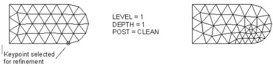
图 5-73 加密指定关键点处的网格
