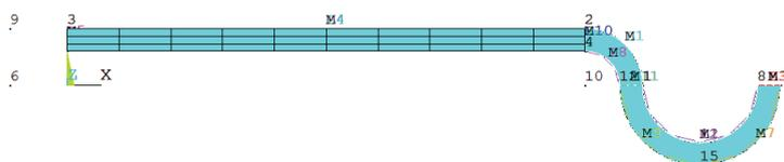
图 5-98 关键点 2、3、5、4 组成的区域网格划分结果
