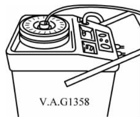
图 1-18 液力变矩器的排空操作
