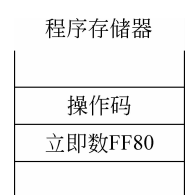
如图 5.1 所示,立即数 FF80 是与操作码一起存在程序存储器中的,指令执行后,将立即数 FF80 加载到累加器 A 中。 图 5.1 程序存储器
