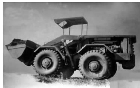
图 1-6 国产 Z435 型装载机外形
