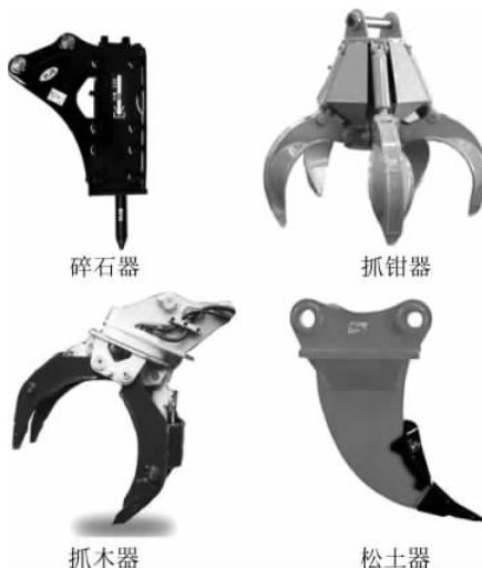
图 1-2 具有不同工作装置的轮式装载机
