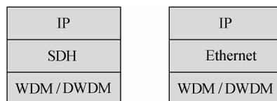
图 3.10 IP over DWDM 协议模型
