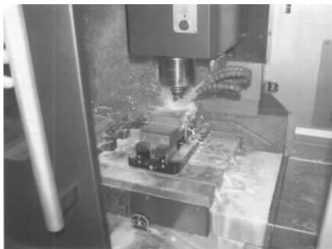
图 3.33 铣削加工时切削液的施加
