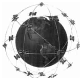
图 TF5-2 GPS 卫星星座示意。每个平面内有 4 颗卫星,海拔 20 200km,轨道倾角 55^\circ
