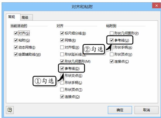
然后，使用鼠标拖动垂直标尺边缘到绘图页中，创建一条垂直参考线。将绘图页中的各个形状拖动到参考线上，当参考线上出现绿色方框时，则表示形状与参考线相连。此时，拖动参考线即可同步移动多个形状。
