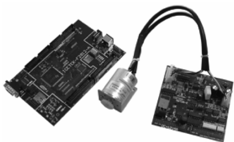
图 5.15 ICETEK-MOTOR-E 控制板和无刷直流电动机
