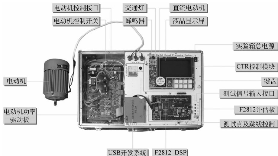
图 5.16 ICETEK-F2812-ACM 实验箱和大功率交流异步电动机
