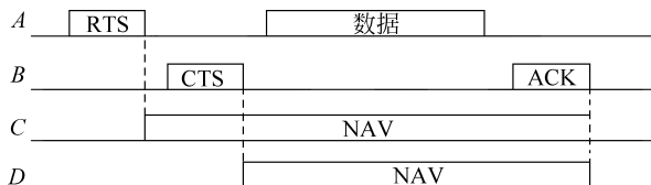
图 3.1 CSMA/CA 的虚拟载波侦听示例
