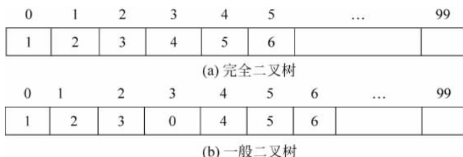
图 3-8 二叉树的顺序存储结构
