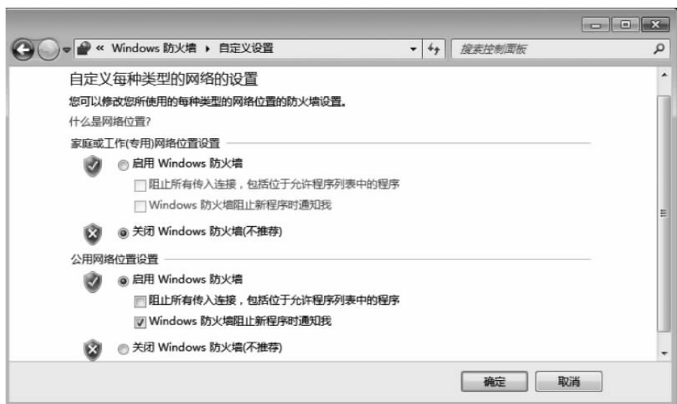
图 3-10 启用 Windows 防火墙
