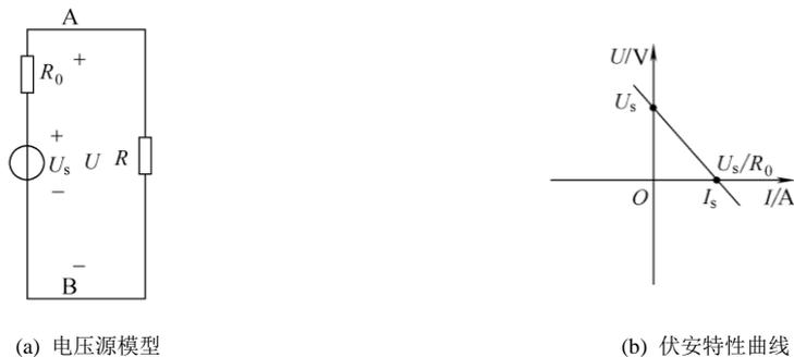
图 1-13 实际电压源模型及伏安特性曲线
