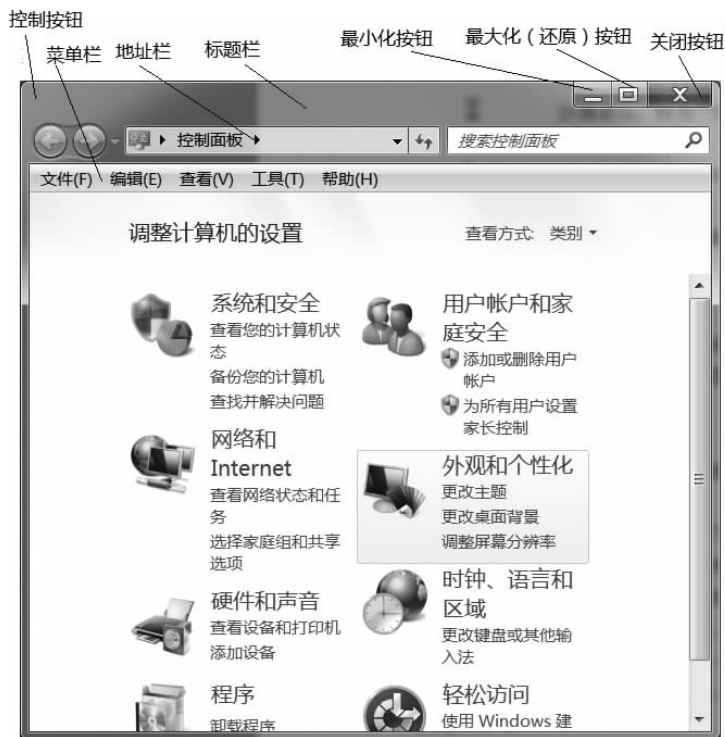
图 5.8 Windows 7 窗口的组成
