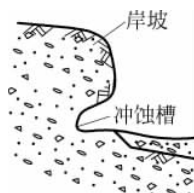
图 1.3 泥石流冲蚀槽
