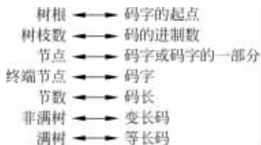
图 5-3 码树与码字对应关系图
