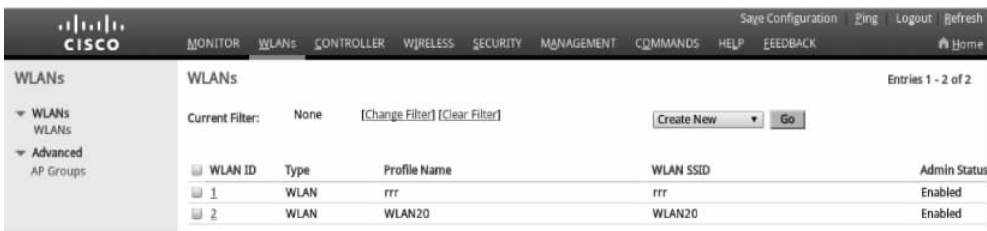
图 5-24 查看 WLAN 的 SSID 配置情况
