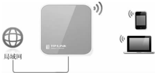
图 5-11 利用无线路由器组建独立无线网络
