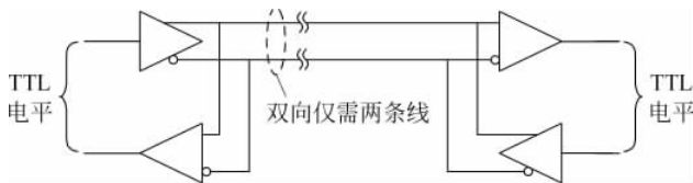
图 3.21 RS-485 的连接方式
