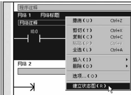
图 3-42 选中程序代码建立状态图
