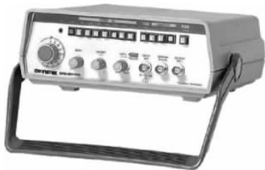
图 5.14 函数信号发生器
