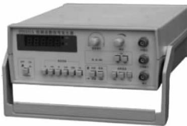
图 5.16 低频信号发生器
