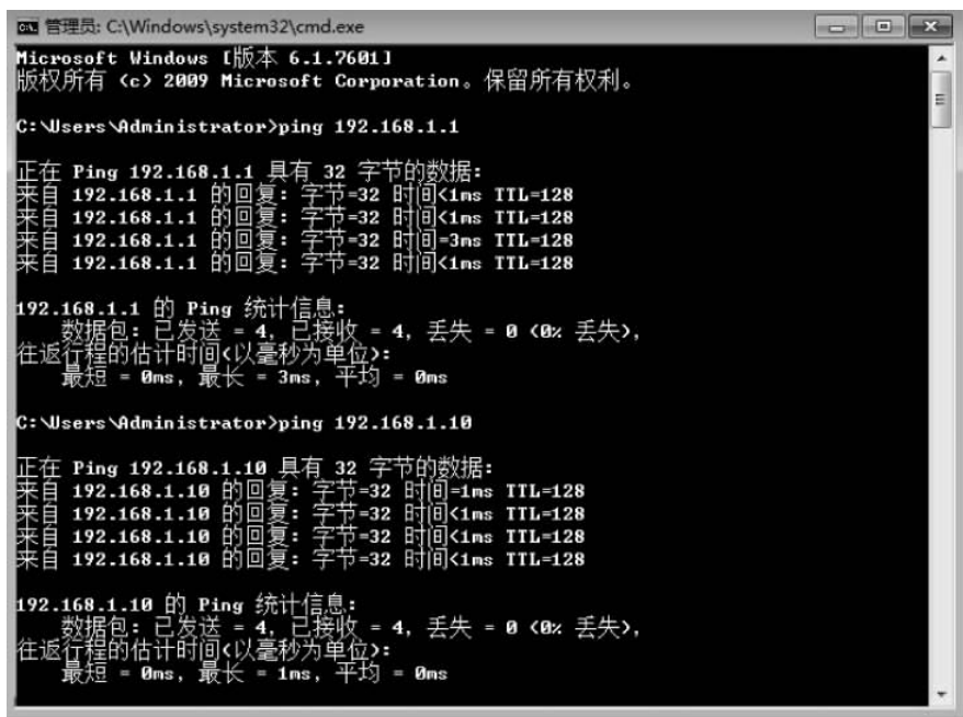
图 3-3-11 用 Ping 命令测试网络连通性
