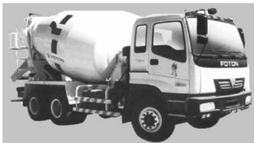
图 3-19 混凝土输送车
