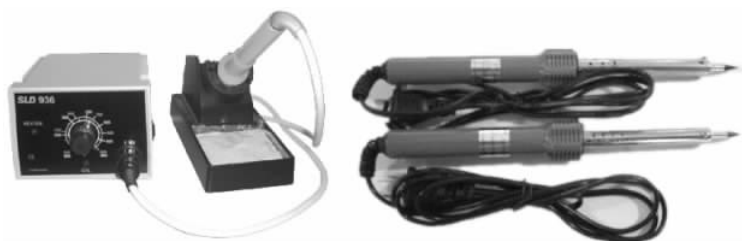
图 3.16 恒温电烙铁和普通电烙铁
