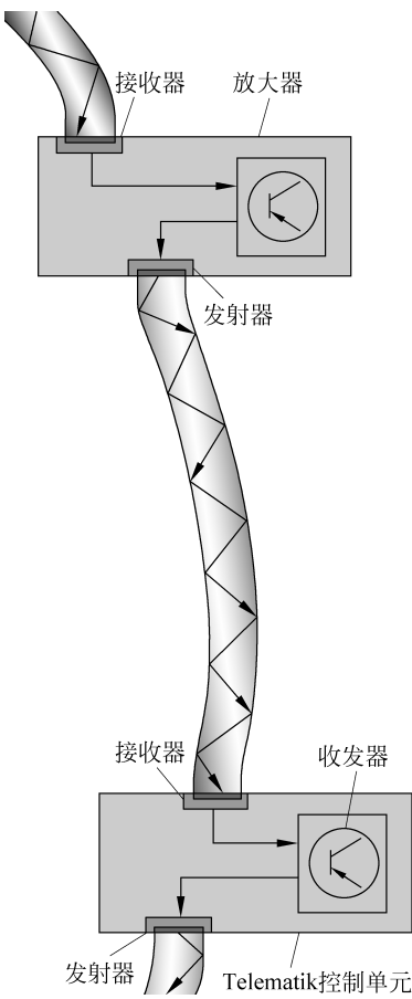
图 3-8 光导纤维的作用是传输光波
