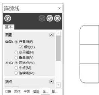
图1-103 绘制两条连接直线
