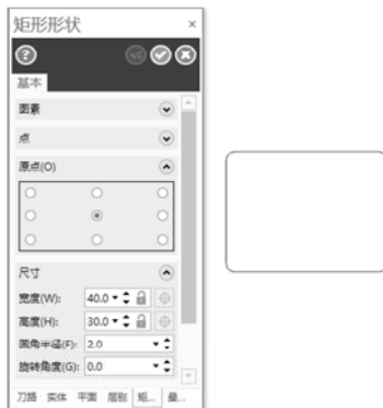
图1-117 绘制 40 \times 30 的圆角矩形
