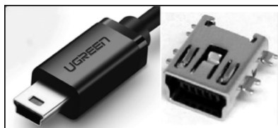
图 30-3 Mini USB 插头(左)和插座(右)
