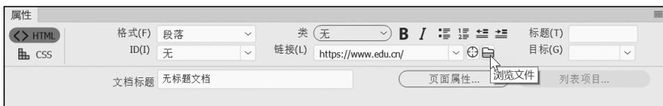
图 5.10 通过文件夹图标制作超级链接
