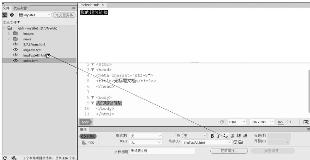
图 5.12 在“属性”面板直接拖曳“指向文件”图标指向要链接的对象
