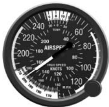
图 1-14 真空速表的盘面
