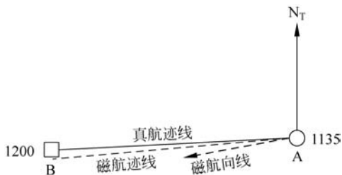
图 3-3 利用航迹角和地速推算飞机位置
