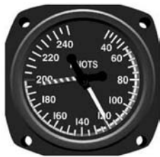
图 1-14 真空速表的盘面
