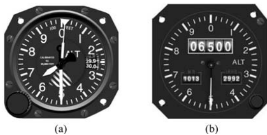
图 1-10 气压式高度表表面
