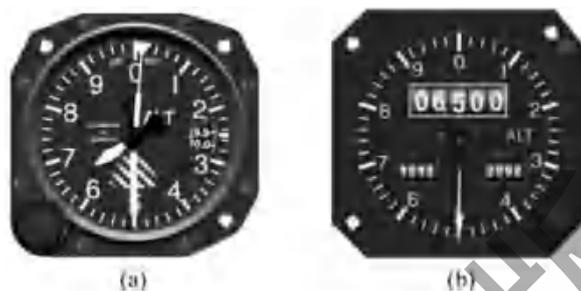
图 1-10 气压式高度表表面
