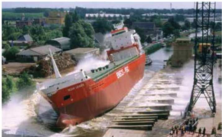
横向涂油滑道下水的船舶
