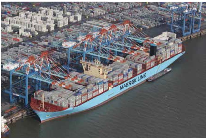
正在进行集装箱装卸作业的集装箱船
