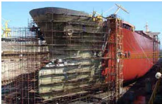
正在进行船壳整体装配的商船
