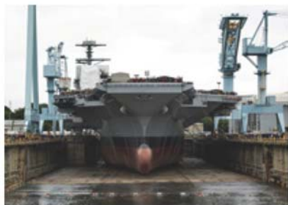
采用固定船坞式下水方式的美国“福特”号航母
