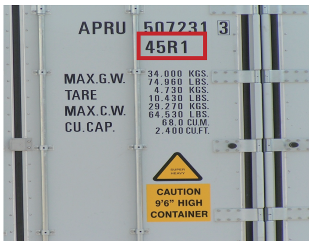
图1-7 尺寸和箱型代码
