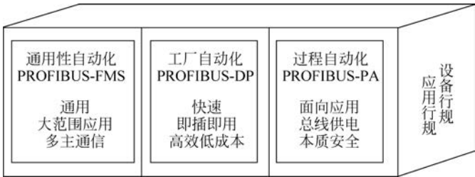
图 3-3 PROFIBUS 总线的三个版本
