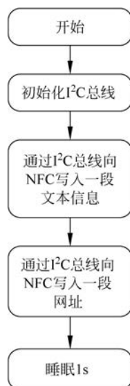
图 5.5.2 主程序流程图
