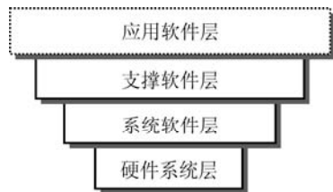
图 5-2 计算机系统层次结构
