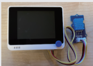
图 5-3 连接到 Wio Terminal 右边插座的 Grove 温湿度传感器
