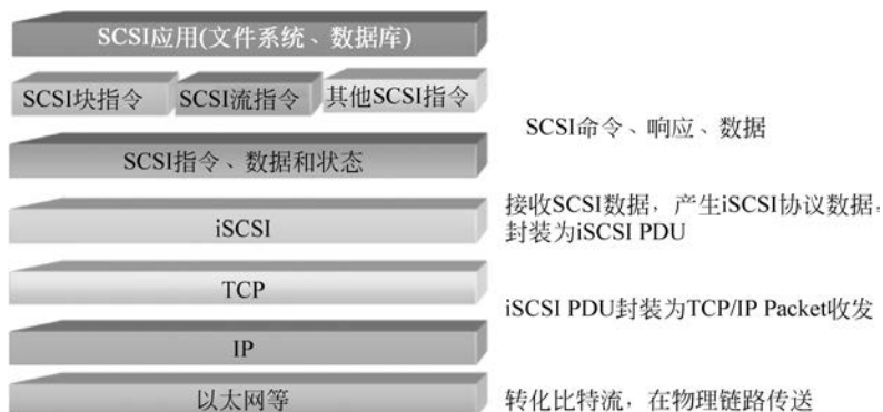
图 5.20 iSCSI 协议栈
