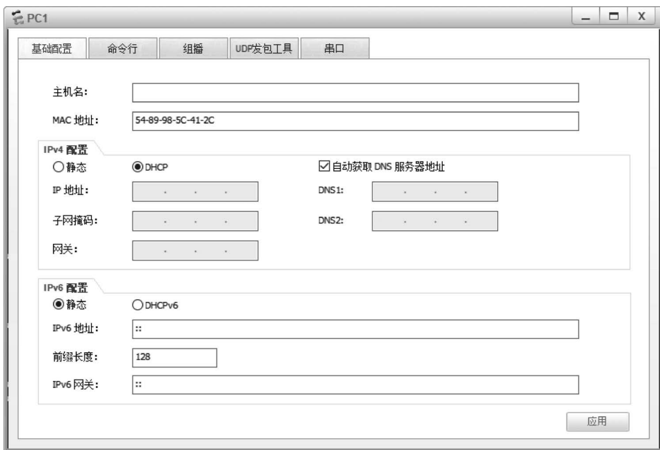
图 3-35 终端自动获取 IP 地址设置
