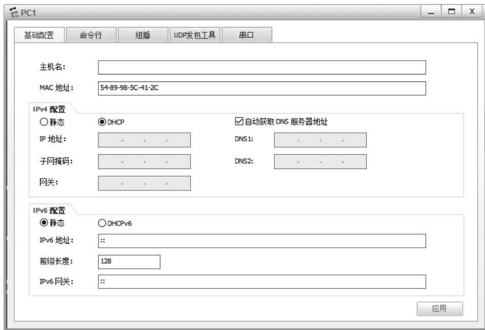
图 3-26 终端自动获取 IP 地址设置
