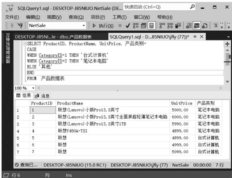
图 5-45 CASE 构造的条件分支结构执行结果
