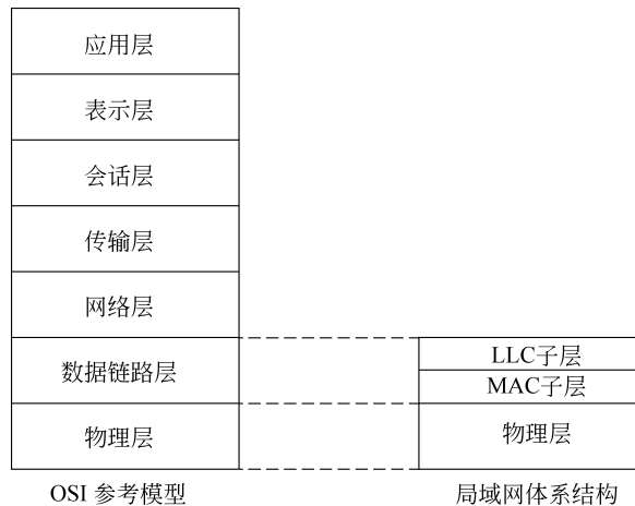
图 5.1 局域网体系结构与 OSI 参考模型的对应关系
