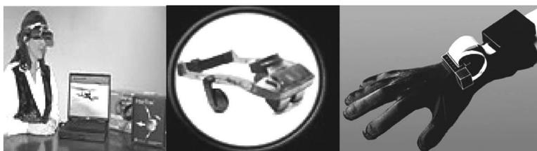
图 5-10 虚拟现实系统、三维头盔和数字手套
