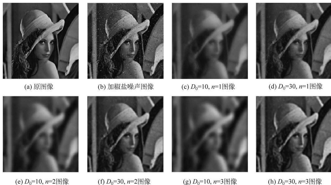
图 5.13 利用巴特沃斯低通滤波器进行图像去噪实验结果
