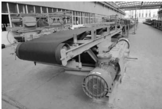
图 5-9 皮带机的大致结构
